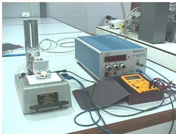
Hình 4 : Thí nghiệm đo điện trở màng mỏng HBKHN
